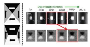
para visualizar cuantitativamente ondas acústicas superficiales y utilizarlas para modificar la imanación de nanoelementos magnéticos sobre la capa superficial de un cristal piezoeléctrico. El experimento se realizó en la línea de luz CIRCE del Sincrotrón ALBA, utilizando el microscopio de fotoemisión (PEEM) y se ha publicado en *Nature Communications*.
