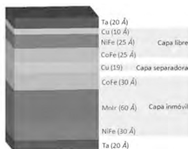
Figura 1. Estructura multicapa del sensor de válvula de espín propuesto (espesor en Å).
