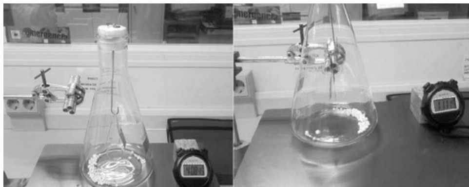
Figura 3. Electroscopio sin presencia de la fuente de ^{241}\text{Am} (izquierda) y con la fuente de ^{241}\text{Am} (derecha)
