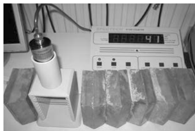
Figura 1. Dispositivo experimental para el laboratorio remoto con el contador Geiger-Müller y barreras de plomo
