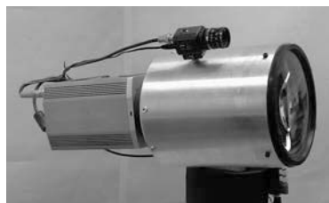
Figura 1. Detalle del espectrógrafo con cámara CCD RS Quantem en su parte posterior y cámara IP sobre el mismo.
