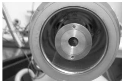
Figura 1. Detector de Si(Li) sin ventana de berilio.
