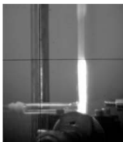
Figura 2. Plasma acoplado a la generación del hidruro del As.
