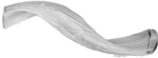
Figura 1. Potencial electrostático en el dispositivo TJ-II mostrando un modo desestabilizado por gradiente de temperatura iónica (ITG). En rojo los valores positivos, en azul los negativos.
