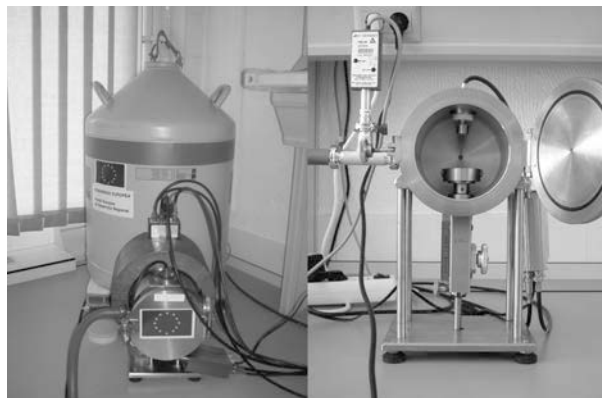
Figura 1. a) Dispositivo para medir coincidencias alfa-gamma. b) Cámara de baja geometría.
