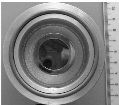
Figura 1. Cámara de aluminio portátil, con detector de semiconductor de Silicio, para la detección de partículas alfa.
